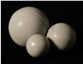
Eine aktuelle Fragestellung betrifft die Mindesttragfähigkeit von Platten aus Gradientenbeton unter lokalen Einzellasten im Bereich des Hohlkugel - Scheitelpunktes. Anhand von FE-Simulationen soll das Tragverhalten für verschiedene Betonüberdeckungen simuliert und durch kleinmaßstäbliche Versuche validiert werden.
