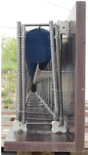
Innerhalb des Teilprojekts C02 des Sonderforschungsbereichs 1244 wird interdisziplinär die Integration fluidischer Aktoren in biegebeanspruchte Bauteile untersucht. Im Fokus steht dabei die Integration in Stahlbetonplatten, da diese einen Großteil der Tragwerksmasse typischer Hochbauten verantworten. Mit Hilfe der Aktoren lässt sich das Tragverhalten der Platten manipulieren, sodass Material und die damit verbundenen grauen Emissionen eingespart werden können.
