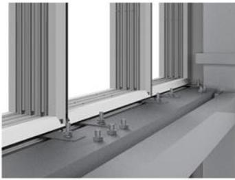
Abbildung 72: Anschluss der Fassade mit dem Profilsystem 'Curtain' an das Demonstrator-Hochhaus
